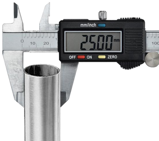
Abbildung 1 - Messen des Rohraußenmaßes mit einem Messschieber. In diesem Beispiel: 25 mm
