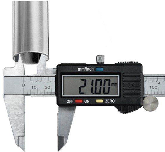
Abbildung 3 - Messung des Rohrinneinmaßes mit einem Messschieber. In diesem Beispiel beträgt das Innenmaß 21 mm
