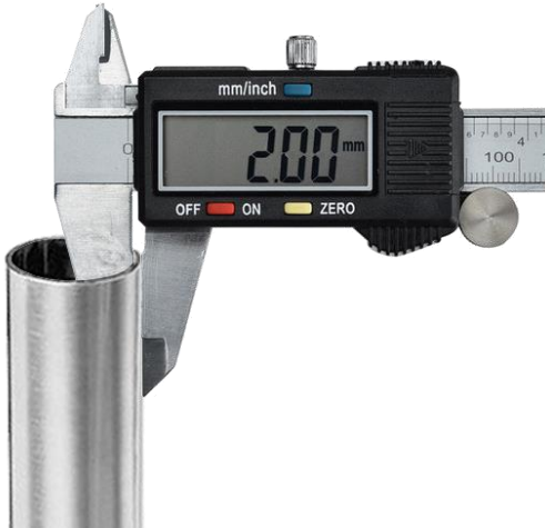
Abbildung 2 - Messen der Wandstärke mit einem Messschieber. In diesem Beispiel beträgt die Wandstärke 2 mm
