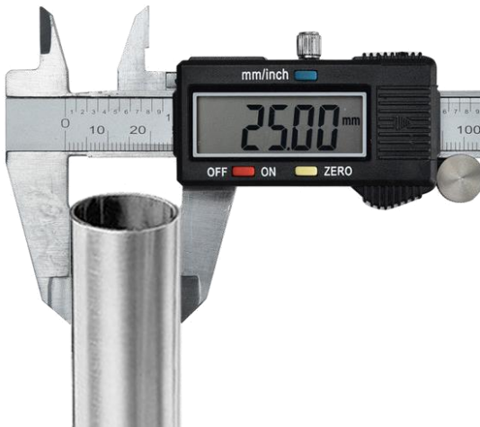
Abbildung 1 - Messung des Außenmaßes des Rohrs mit einem Messschieber. In diesem Beispiel: 25 mm
